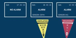
Abb. 2 Messergebnisse von Containermessungen mit dem GDA-F und daraus abgeleitete Handlungsanweisungen.
