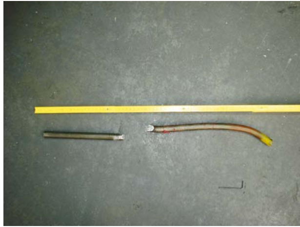
Werkstück, eingespannter (links) und abgebrochener Teil (rechts)
