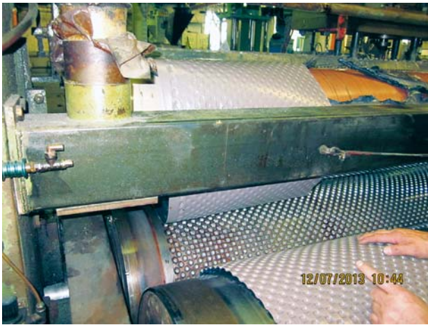
Offene Eingriffstelle zum Zeitpunkt des Unfalls
