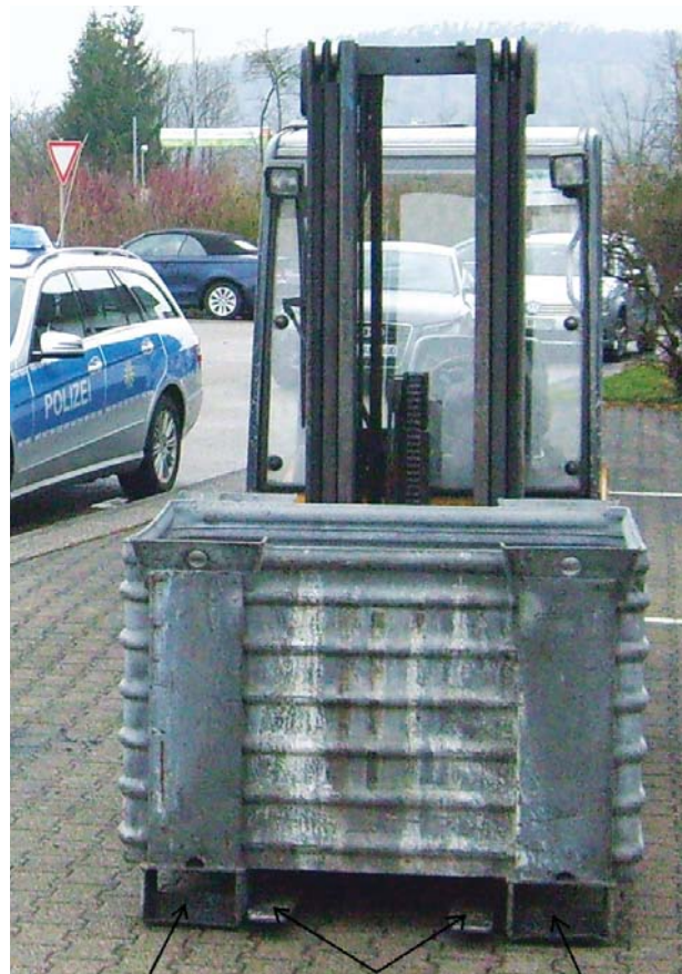
Nachgestellte fehlerhafte Lastaufnahme
