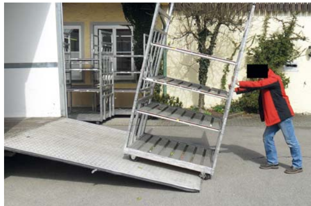
Entladen eines Etagenwagens für Schnittblumen über Laderampe
