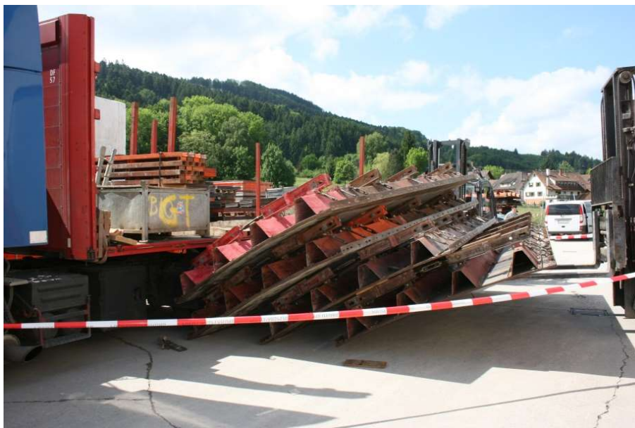
Bild 1: Abrutschen der Metallteile vom Gabelstapler
