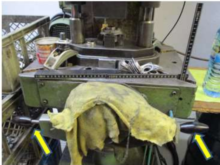
Bild 2: Tisch der Exzenterpresse mit Stanzwerkzeug und eingelegtem Werkstück; im Vordergrund: Hebel der Zweihandbedienung
