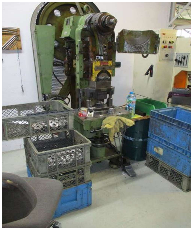
Bild 1: Exzenterpresse mit Fußpedal ohne Schutzvorrichtung gegen unbeabsichtigtes Auslösen des Stanzvorgangs
