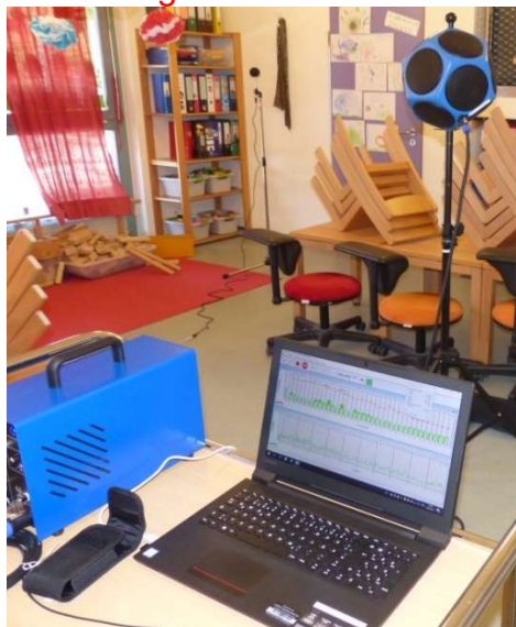
Bild: Messsystem zur Erfassung der Nachhallzeit (LUBW)
