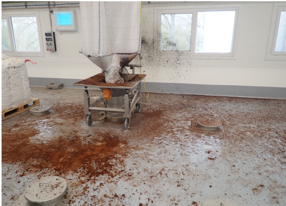
Bild: Abfüllstation nach der Staubexplosion
