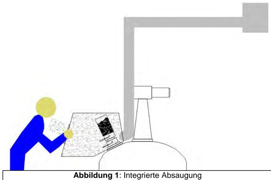
Abbildung 2 zeigt eine integrierte Absaugung mit offenem Handling innerhalb der Absaugung.
