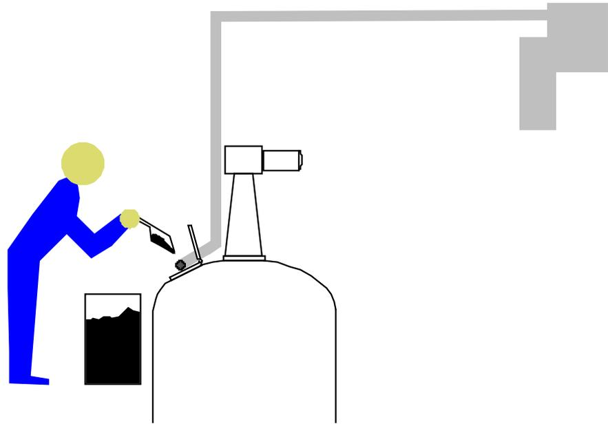
**Abbildung 5:** Quellenabsaugung
