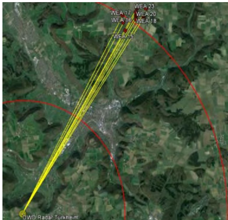
Abbildung 39: Bezug zwischen dem Radarstandort und dem Standort der WEAs. Die Distanzkreise von 5 km, 10 km und 15 km sind zusätzlich gekennzeichnet. [10]
