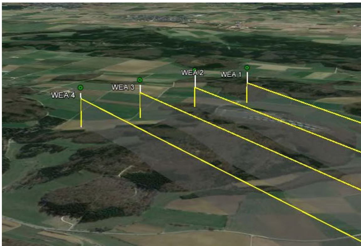
Abbildung 65: Übersicht über die Richtungsbezüge des WEA-Standortes zum Radarstandort Türkheim unter Berücksichtigung der Topografie. [10]
