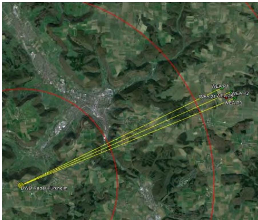
Abbildung 51: Bezug zwischen dem Radarstandort und dem Standort der WEAs. Die Distanzkreise von 5 km, 10 km und 15 km sind zusätzlich gekennzeichnet. [10]
