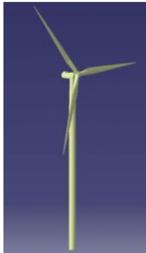
Abbildung 69: N100: Rotoransicht bei 45° Winkel zwischen Rotorachse und Bezugsrichtung zum Radar
