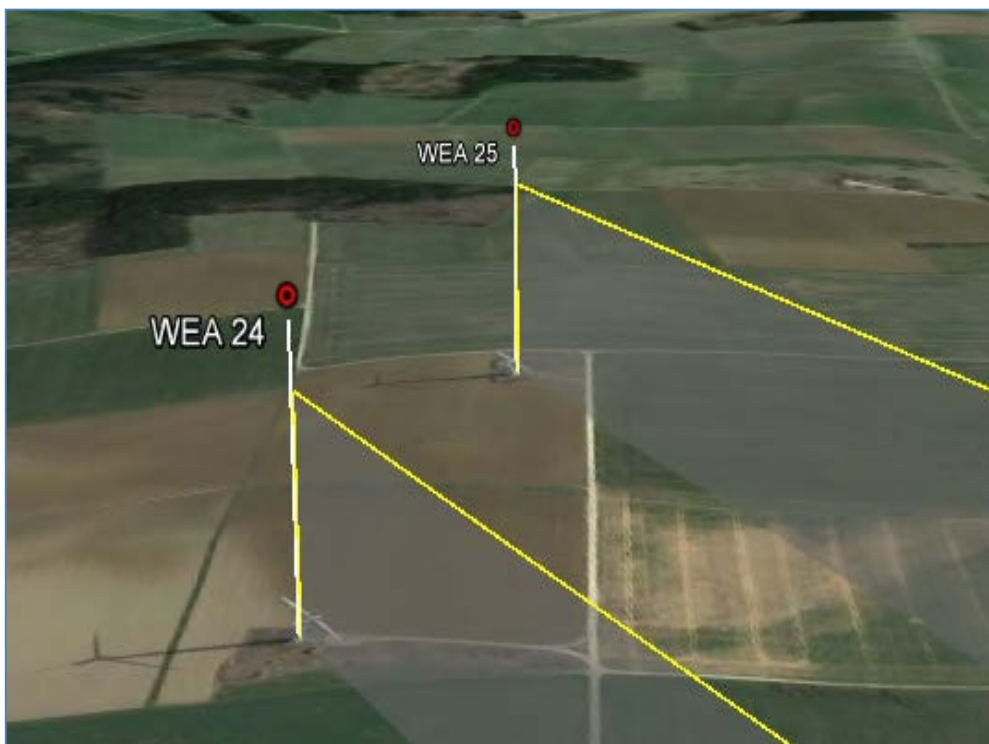
Abbildung 36: Übersicht über die Richtungsbezüge des WEA-Standortes zum Radarstandort Türkheim unter Berücksichtigung der Topografie. [10]
