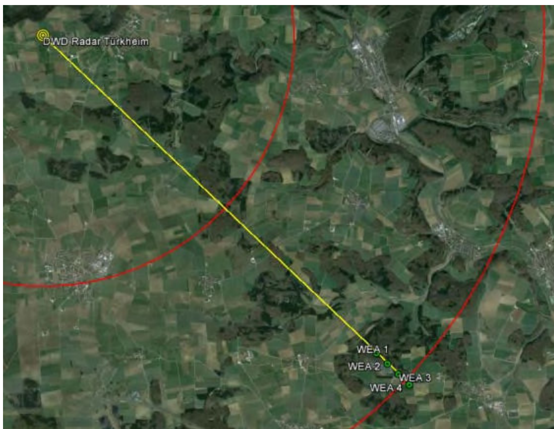
Abbildung 60: Bezug zwischen dem Radarstandort und dem Standort der WEAs. Die Distanzkreise von 5 km und 10 km sind zusätzlich gekennzeichnet. [10]
