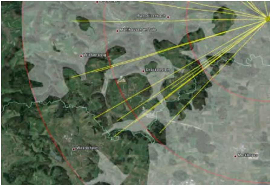
Abbildung E2: Grau dargestellt sind beispielhaft in südwestlichen Richtungen die Geländeflächen, die eine Antennenhöhe von 765 m ü. NN nicht überragen. Andere Richtungen zeigen niedrigere Geländehöhen. [10]
