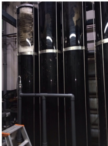
Abbildung 3 Airlift-Reaktoren zur Belüftung des Kreislaufwassers
