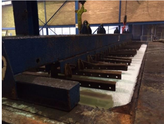
Abbildung 2 Becken mit eingetauchtem Verzinkungsgut
