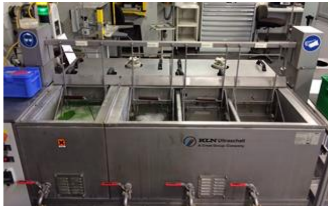
Abbildung 1 Arbeitsplatz Reinigungsanlage mit Enzymen (Bad 1 und 3 von links)
