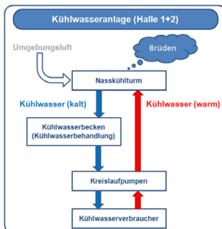
Abb. 1 Übersicht über das Kühlwassersystem
